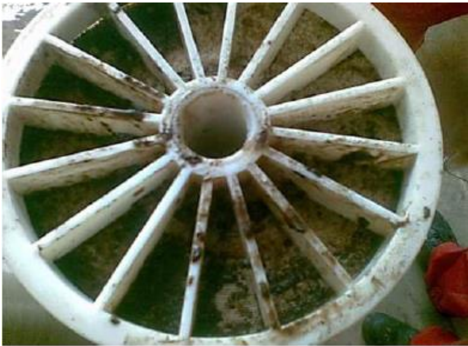
شکل ۲: نمایی از تشکیل ریز رسوب ها روی ممبران آب شیرین کن RO
