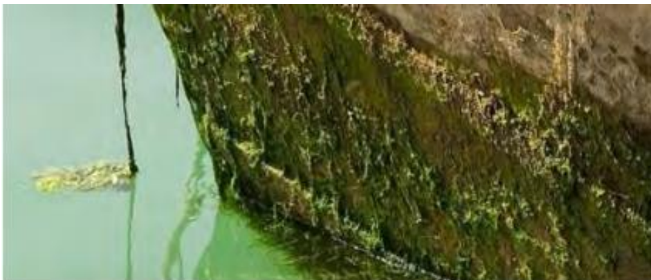
شکل ۳: نمایی از تشکیل درشت رسوب ها روی بدنه کشتی
