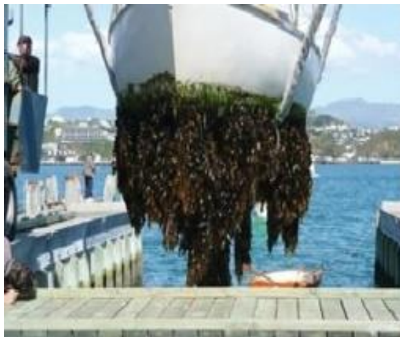
شکل ۶: ایجاد بیوفولینگ روی بدنه کشتی ها
