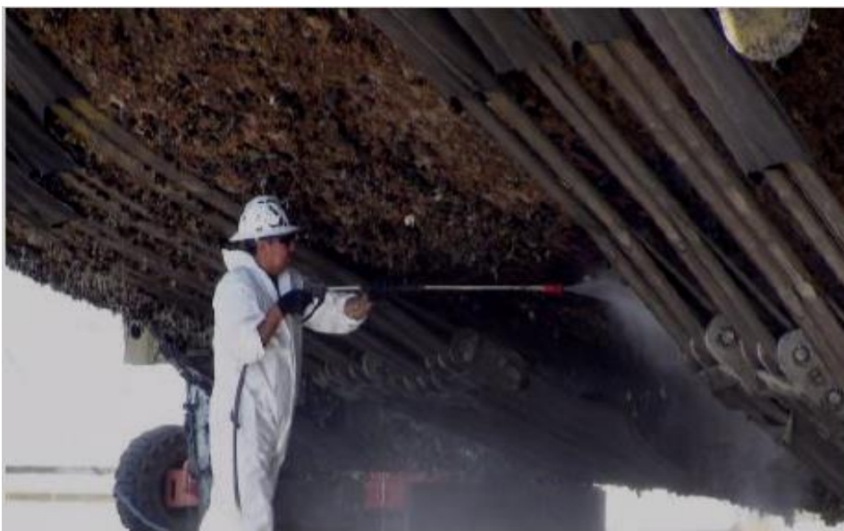
شکل ۱۱: استفاده از واتر جت برای پاکسازی بیوفولینگ
