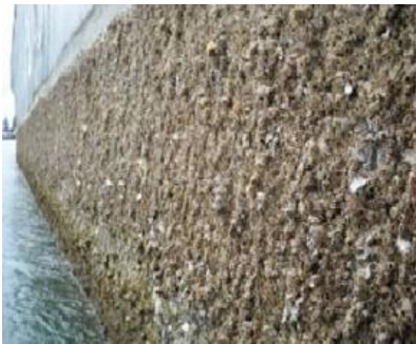
شکل ۶: ایجاد بیوفولینگ روی بدنه کشتی ها
